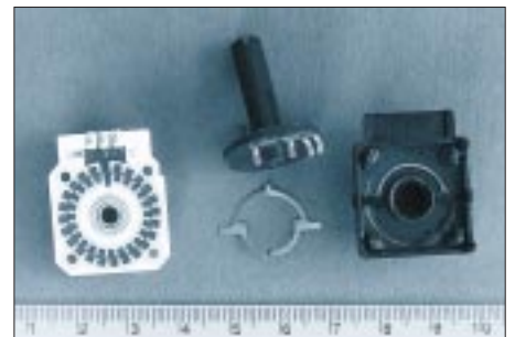
Bild 2: Der Schaltencoder ECW1J-B24 im zerlegten Zustand. Von links: Keramikplatte mit Schaltkamm, Raste aus Federmessing, Rotor (die 4 Schleifkontakte haben eine gemeinsame Basis, die beiden linken sind zuständig für den Mittelkontakt, dann folgt der innere für Kanal B, rechts der für außen, Kanal A) mit Rastnut, rechts das Gehäuse.
