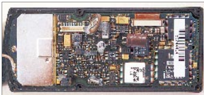
Ein Blick ins Innere des Geräts zeigt wenige, hochspezialisierte Elektronik, u.a. einen 80386-Prozessor zum Aufbereiten der Bedienfunktionen.
