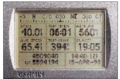
Die eigentliche Positionsseite zeigt u.a. die Bewegungsrichtung und mehrere, eigenen Bedürfnissen anpaßbare Datenfelder, beispielsweise Höhe und Geschwindigkeit.
