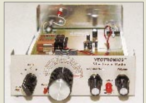
Der VEC-104 von Vecronics ist ein einfacher KW-Audion-Bausatz für 3,5 bis 22 MHz in fünf Teilbereichen.
