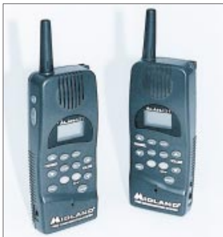
Bild 1: Das neue ALAN-431-LPD bietet eine integrierte VOX-Elektronik (sprachgesteuerte Sende-/Empfangsumschaltung), welche die PTT-Taste überflüssig macht. Eingeführt wird das Modell im Sommer '98 zu einem Preis von ca. 230 DM.
