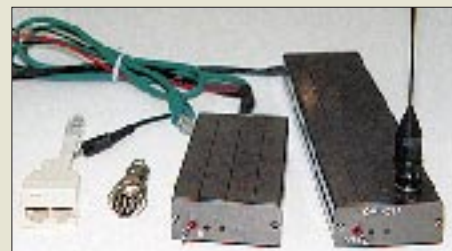
Mit Hilfe der Stationsfernbedienung OM 403A von gaga kann man per Handy die KW-Station steuern.
