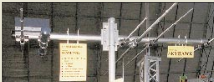
Die Skyhawk von Bencher hat als Besonderheit einen Drehimpulskompensator (das schwarze Rohr im Bild links). Die C-Quad 137 von RF-Systems zum Wetterbildempfang (Bild rechts)
