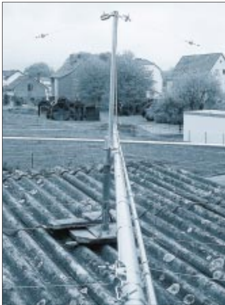
Bild 5: Der Doppelboom mit den Drahtelementen Fotos: DK7ZB
