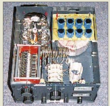
Bei der Ranger 811 H von Linear Amp UK bestechen die spannungsfesten Drehkondensatoren.
