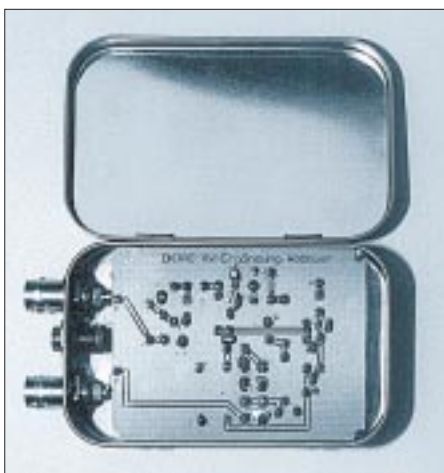
Bild 5: Der Einbau der Platine erfolgt in eine handelsübliche Blechdose.
